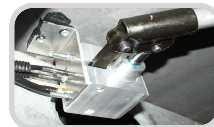
Pompe manuelle de secours.
