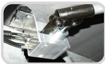
Pompe manuelle de secours.
