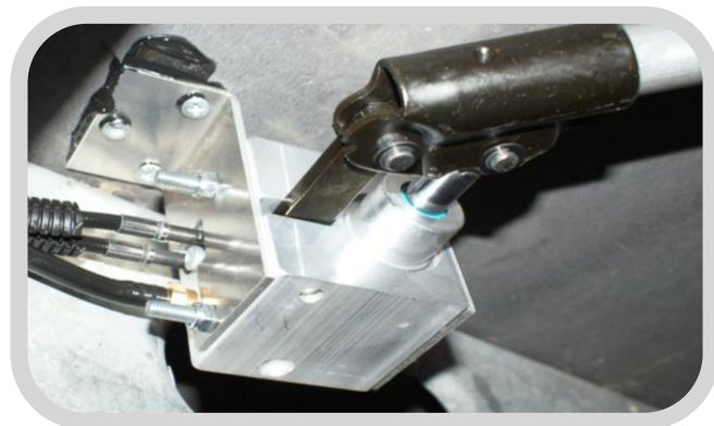
Pompe manuelle de secours.
